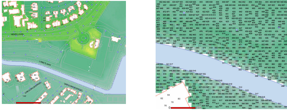
Figuur 2.4 Gridrepresentatie van de laserdata, rechts met hoogtewaarden.
