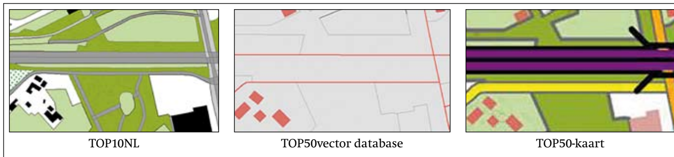
Fig 1. Verplaatsing van objecten in TOP50vector ten behoeve van de symbolisatie als 1:50.000 kaart in het huidige productieproces (zie ook [Van Smaalen en Stoter, 2008]). Merk op dat TOP10NL-wegvlakken lijnen zijn geworden in TOP50 kaart, weergegeven met een lijnsymbool met dikte.
