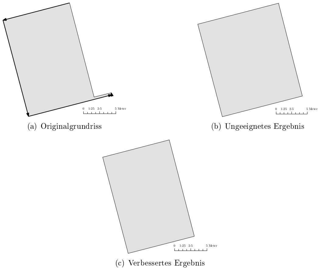
Abbildung 4.2: Vereinfachung eines einfachen, rechtwinkligen Gebäudes mit \varepsilon = 3,0 m.
