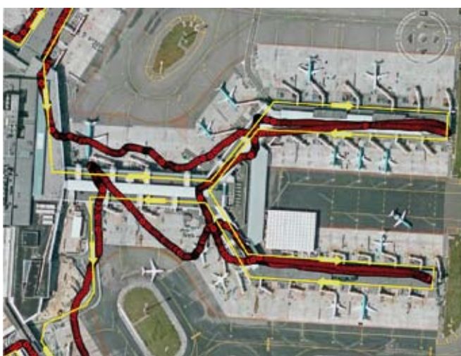
Fig. 7. Gefilterde posities die bepaald zijn voor een experiment met een u-blox-ontvanger op de Schiphol-rondweg onder de D-pier. Links: De uitvoer van het ontvangerfilter geprojecteerd op een Google Earth-foto. Rechts: De resultaten van een eigen filter geprojecteerd op een kaart. In groen is aangeven waar minimaal vier satellietensignalen zijn ontvangen met een C/N0 groter dan 35 dBHz; in rood waar dat er minder zijn dan vier.
