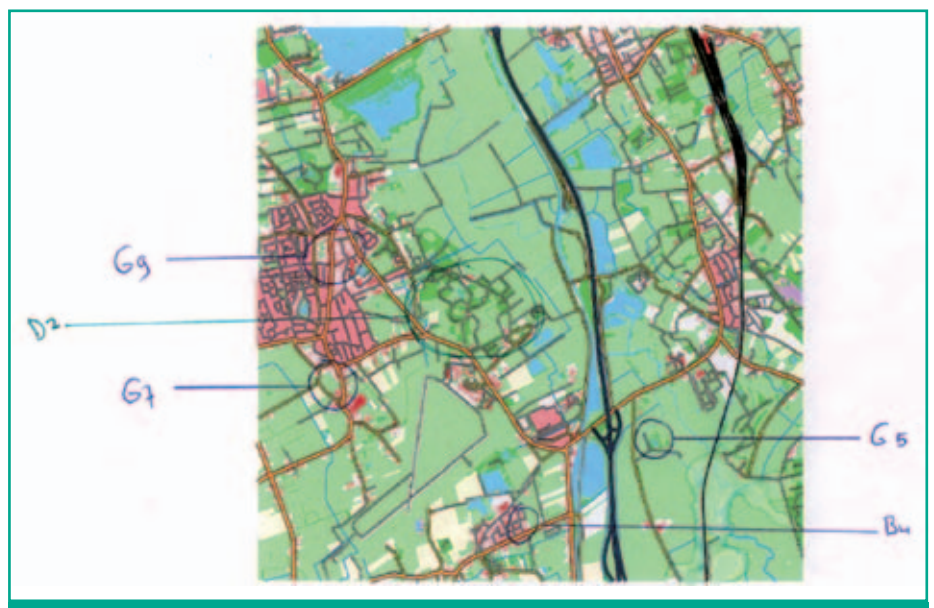
Fig. 6. Testoutput waarin door de kartograaf situaties zijn aangegeven welke volgens hem/haar slecht ('B'), goed ('G') of zeer verschillend ten opzichte van andere output ('D') zijn opgelost.
