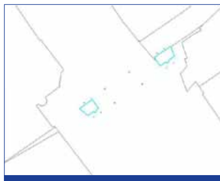
Fig. 2. Kadastrale kaart waarin is aangegeven op welke percelen het Bruggebouw de grond raakt.
