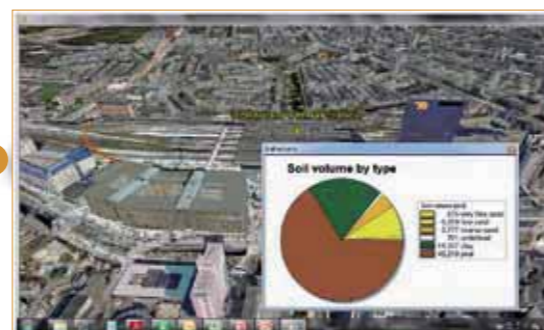
BEREKENING VAN GRONDVERZET DOOR INTEGRATIE VAN VOXEL- EN OBJECTMODEL, ESRI I.S.M. TNO
