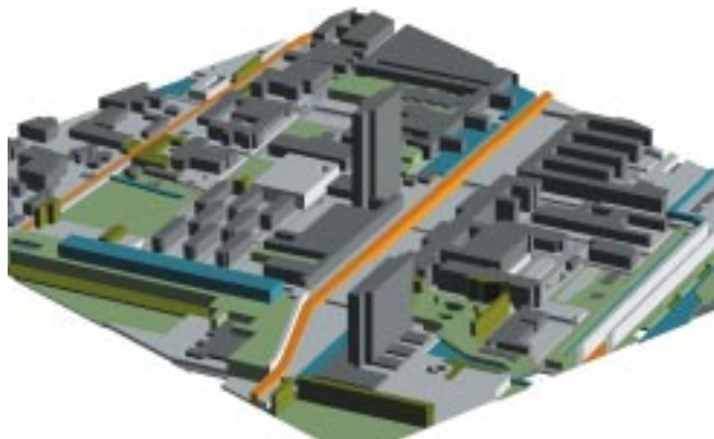
Fig. 3 3D visualisatie o.b.v. 2D geometrie en toegevoegd hoogteattribuut
