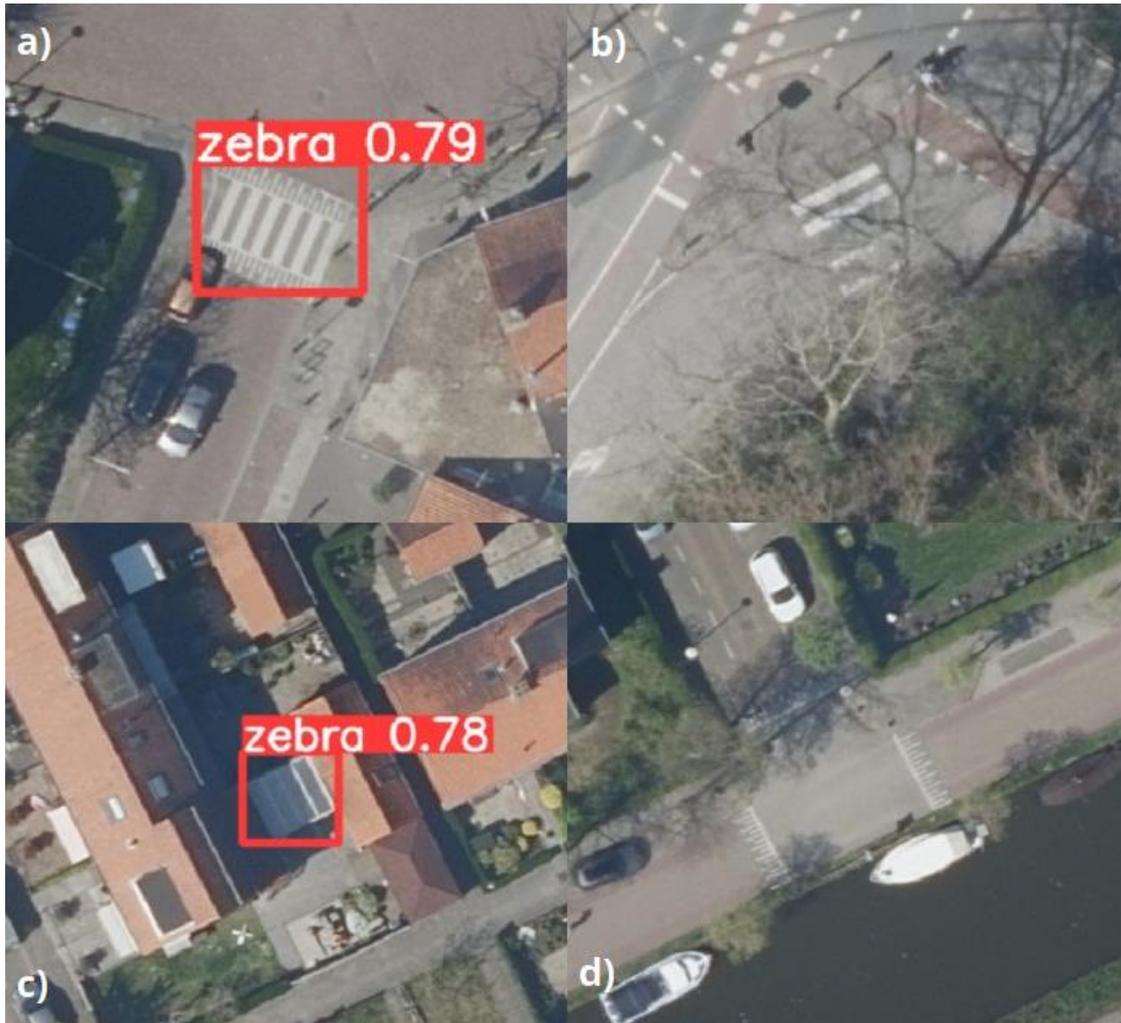
FIGURE 18: CORRECT AND INCORRECT PREDICTIONS. A) TRUE POSITIVE B) FALSE NEGATIVE C) FALSE POSITIVE D) TRUE NEGATIVE
