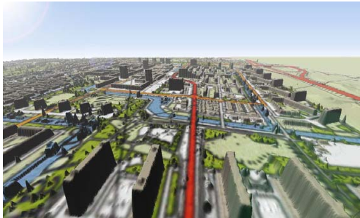
Figuur 4.2 TOP10vector gedrapeerd op ongefilterd AHN (bron: AGI)
