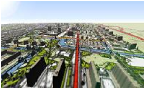
Figuur 1.3 AHN gedrapeerd met raster-afbeelding van TOP10vector
